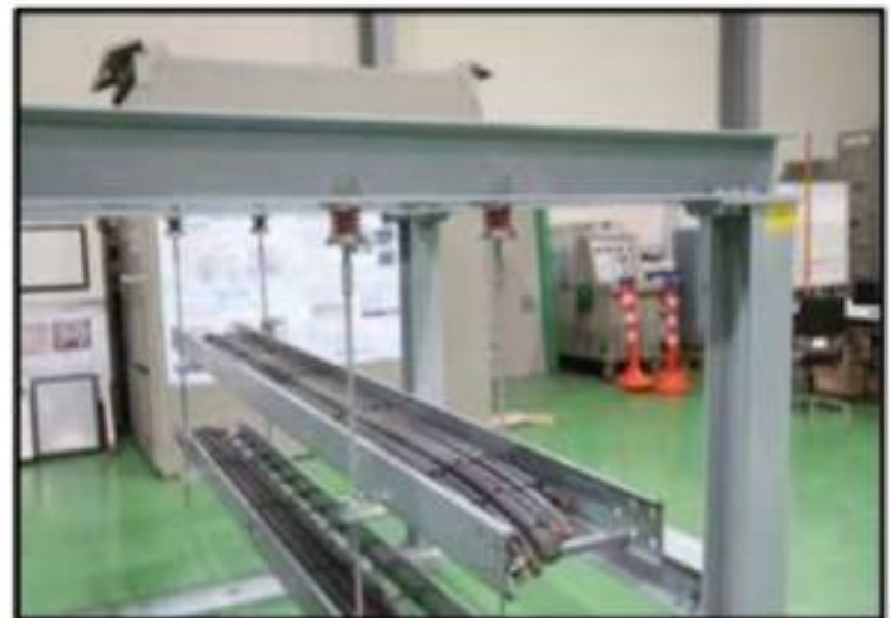
<일신전기 면진내진장치를 이용한 내진 트레이>
